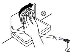
**4.** После чистки поверните фильтр (③) по часовой стрелке и вставьте на место дренажную пробку (②). Закройте дверцу на нижней панели.
