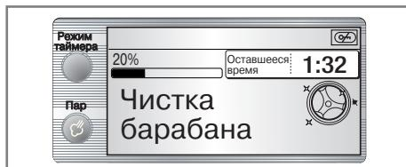
Режим «Чистка барабана» предназначен для очистки барабана стиральной машины. Этот режим использует большое кол-во воды и высокую скорость вращения. Используйте этот цикл регулярно.
