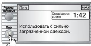
Функцию паровой стирки можно выбрать нажатием кнопки «Пар». При выборе функции паровой стирки, загорается индикатор паровой стирки.
