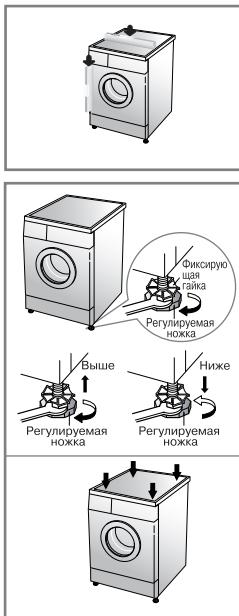
1. Для предотвращения вибрации и чрезмерного шума необходимо придать стиральной машине строго горизонтальное положение.
