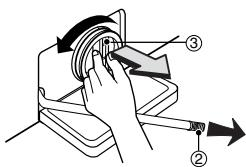
**2.** Выньте дренажную пробку (②), чтобы остатки воды стекли. Подставьте какой-нибудь сосуд, чтобы вода не попала на пол. Когда вода перестанет течь, откройте фильтр дренажного насоса (③), повернув его против часовой стрелки.
