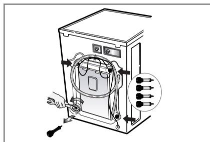
1. Для предотвращения повреждения внутренних деталей машины при транспортировке в машине закреплены 4 транспортировочных болта. Перед началом эксплуатации машины эти болты необходимо удалить вместе с резиновыми заглушками.
